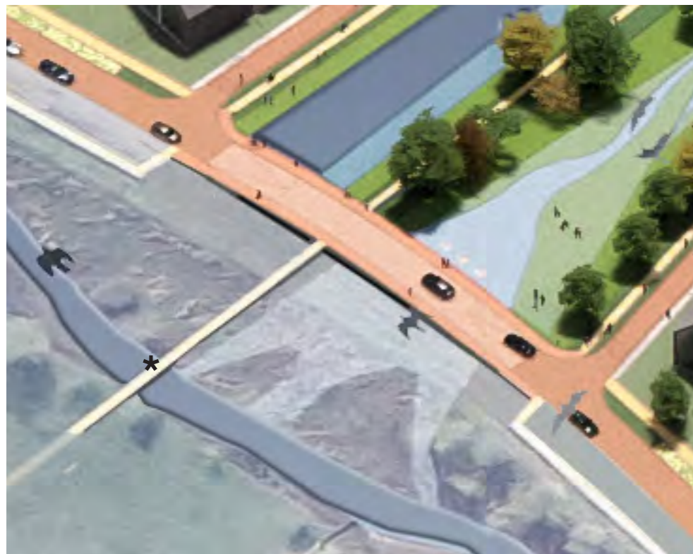
Het brug-effect wordt gecreëerd door het profiel van de Beekweide visueel smaller te maken: de voetpaden tegen de rijbaan aan schuiven, lage brugleuning aanbrengen, het deel van de weg licht verhogen.
