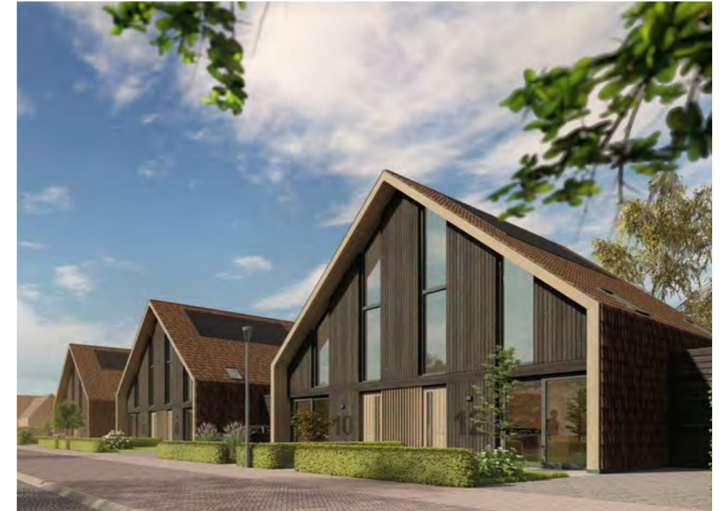
Nokrichting is in basis haaks op de straat, twee woningen onder een grote kap
